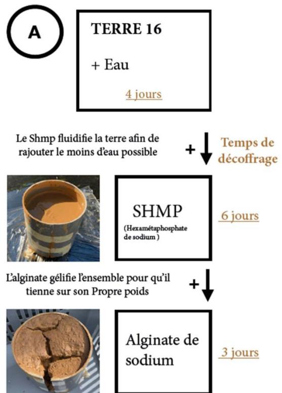
Figure 18 : Tableau : Protocole A : SHMP / Alginate
