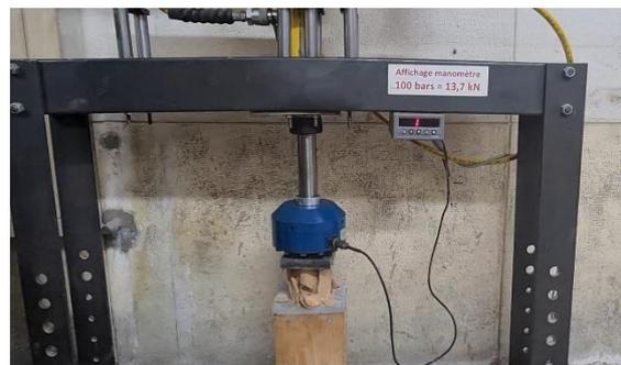
Figure 27 : Photo : Compression du mélange Terre / plâtre Compressé
