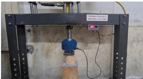
Figure 26 : Photo : Compression du mélange Terre / Plâtre
