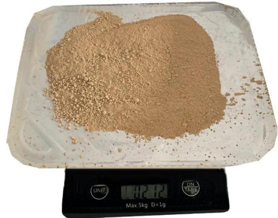
Figure 32 : Photo : Mélange Terre / Plâtre concassé et pesé après four
