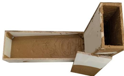
Figure 31 : Photo : L-Box après écoulement
