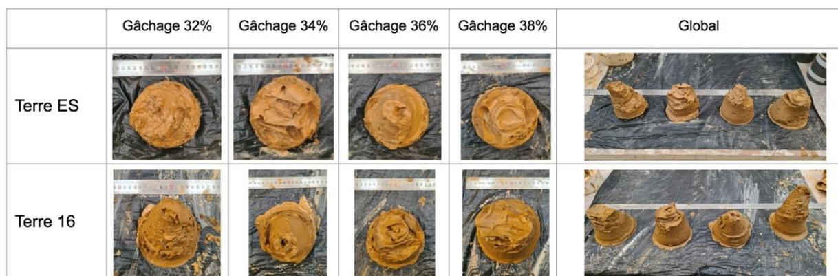
Figure 16 : Tableau : Etalement des terres à l'aide du cône d'Abrams (taux de gâchage, les tous 2%)
