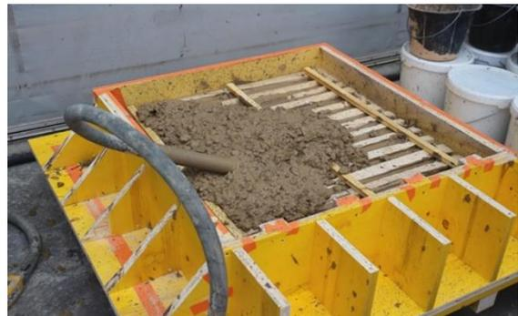
Figure 8 : Tests terre coulée sur coffrage à plat : AMACO et Philippe Madec.
