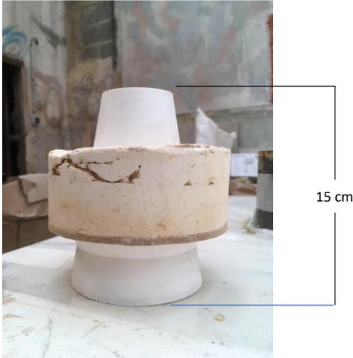
Figure 13 : Photo mini cône d'Abrams
