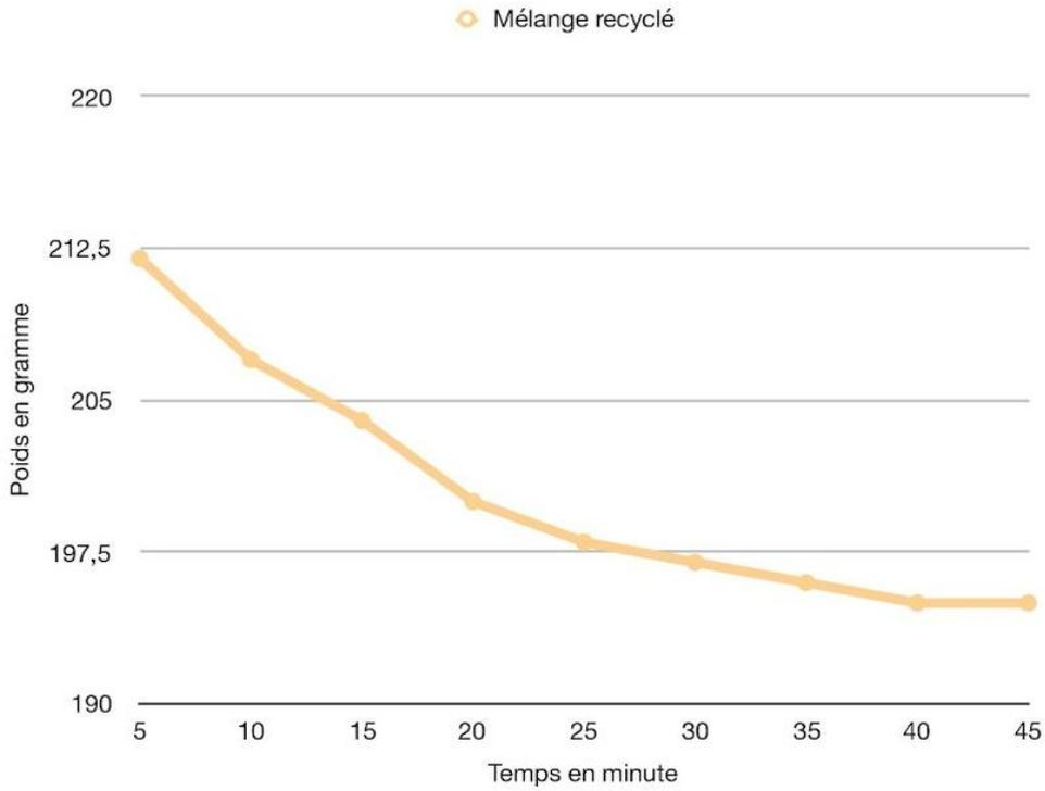
Figure 33 : GRAPHIQUE : Mise en relation entre la perte de poids et le temps lors du passage au four du mélange
